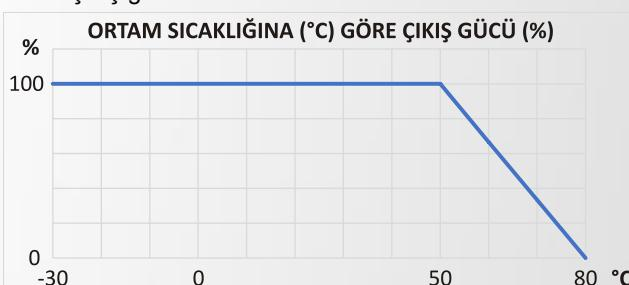
Cihaz +50°C üzerindeki bir ortam sıcaklığında çalışmaya zorlanırsa (veya havalandırması engellenirse) çıkış gücünü azaltarak normal çalışmasına devam eder ve kendini bozulmaktan korur.
