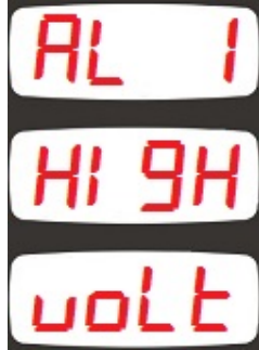
Alarm 1 : Yüksek Gerilim Alarmı
