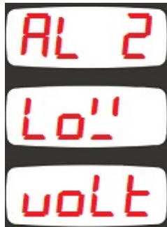
Alarm 2 : Düşük Gerilim Alarmı
