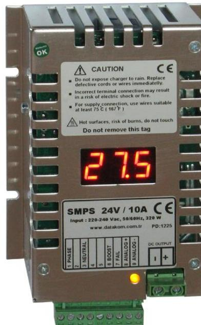
Cihazlarda standart olarak redresör arıza çıkışı bulunur. Bu, cihaz çalışmazken (-)'ye çeken bir transistor çıkıştır. Bu sayede redresör arızası durumunda da jeneratör kumanda sistemine hata sinyali gönderilebilir ve alarm verilmesi sağlanabilir.
