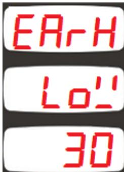
Bu parametre toprak kaçak için toprak geriliminin giriş gerilimine oranının alt limitini ayarlar.
